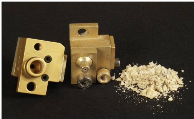
mechanisch entfernte Innenverkrustung / mechanically removed internal contamination
